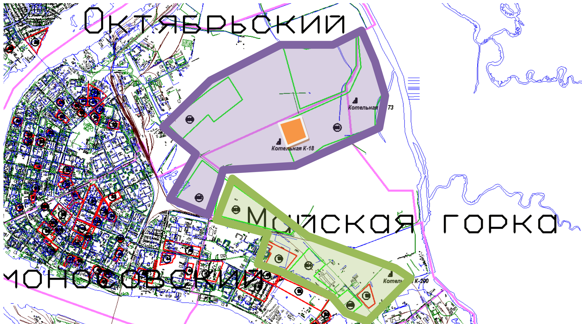
Рисунок 3.2 - Зоны действия предлагаемых к строительству котельных
