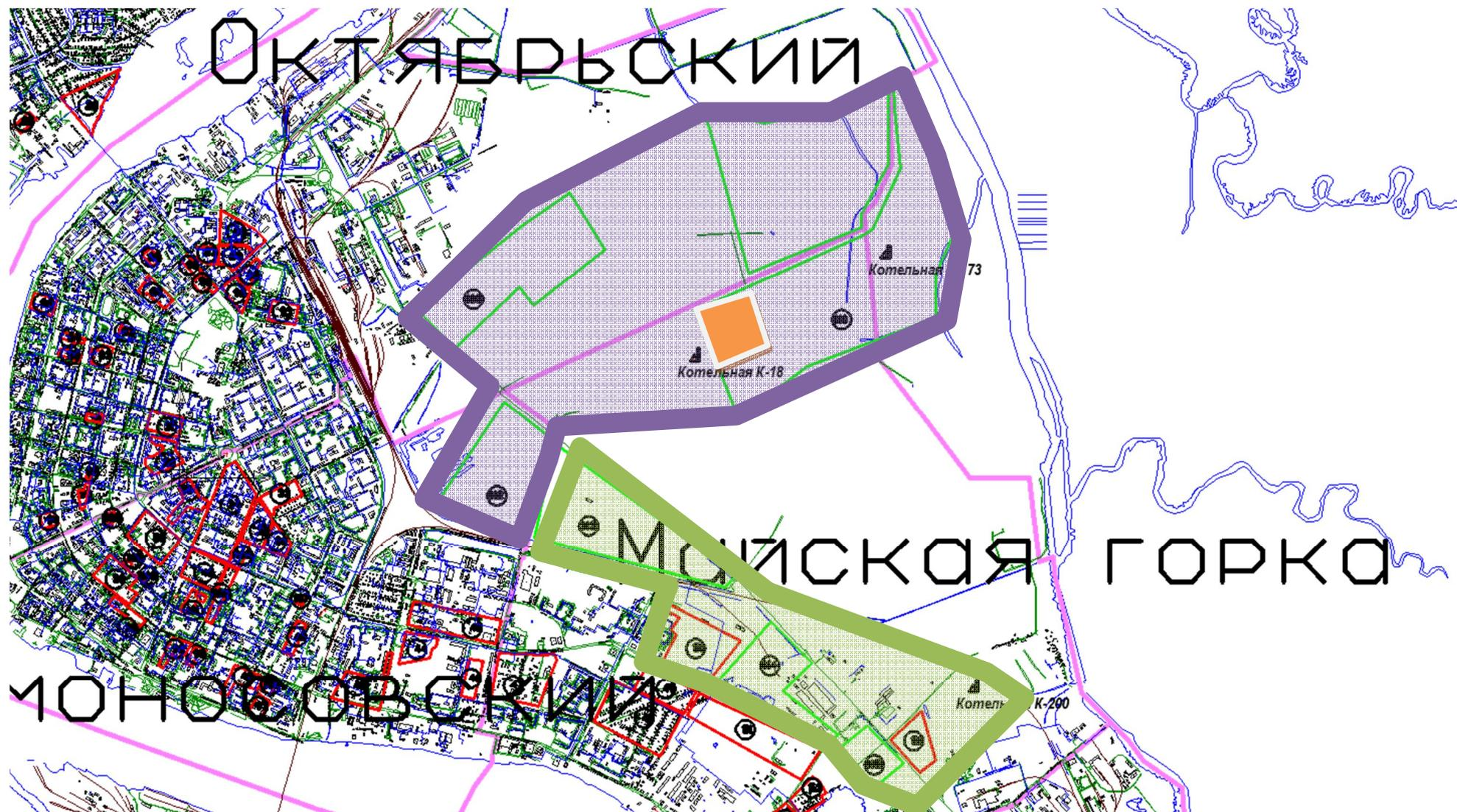
Рисунок 3.2 - Зоны действия предлагаемых к строительству котельных
