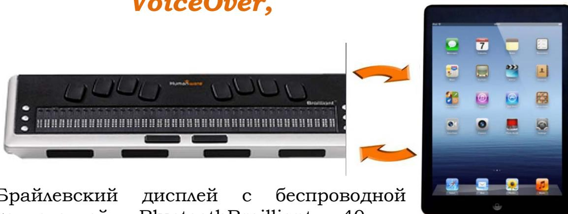
Брайлевский дисплей с беспроводной технологией BluetoothBrailiant 40 в комплекте с планшетным персональным компьютером со встроенной технологией голосового сопровождения интерфейса VoiceOver позволяет детям с нарушением зрения услышать описание объекта, которого они касаются на экране планшетного персонального компьютера.
